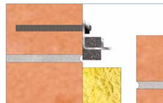
Bevestiging met draadstang M8 + chemische verankering
