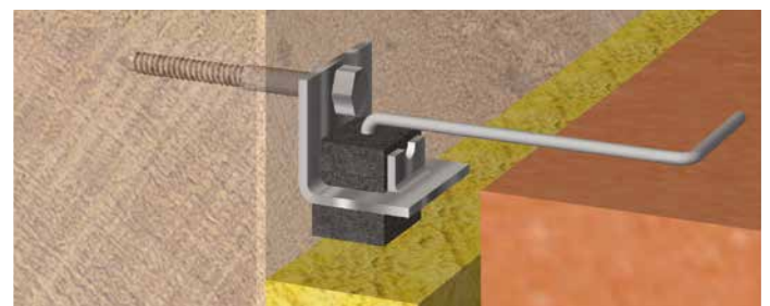
U-vormige houder inwerken in de metselwerkvoegen
