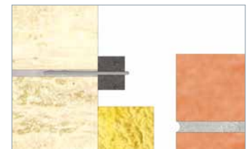
U-vormige houder inwerken in de metselwerkvoegen
